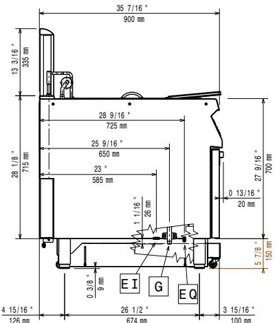
**EI** = Conexión eléctrica (energía)
